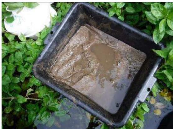
Homogénéisation des 3 sous-échantillons
